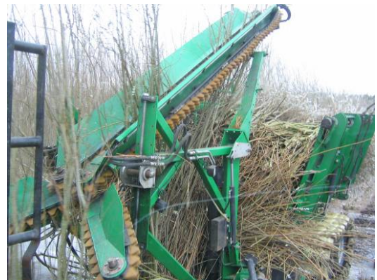
Kæderampen, der griber de afskårne pileskud og fører dem om på vognladet.
