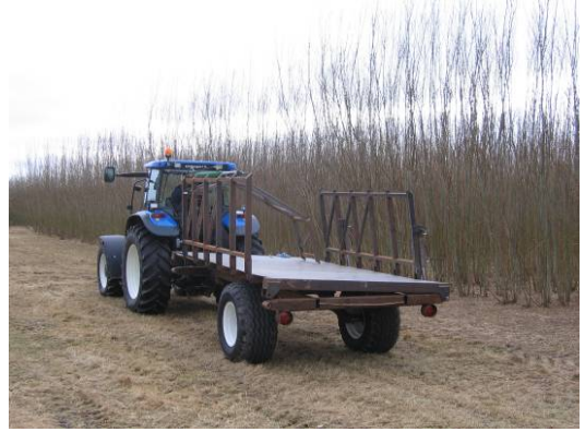
Specialbygget vogn til transport af pileskud fra stemsteren hen til markbunke.
