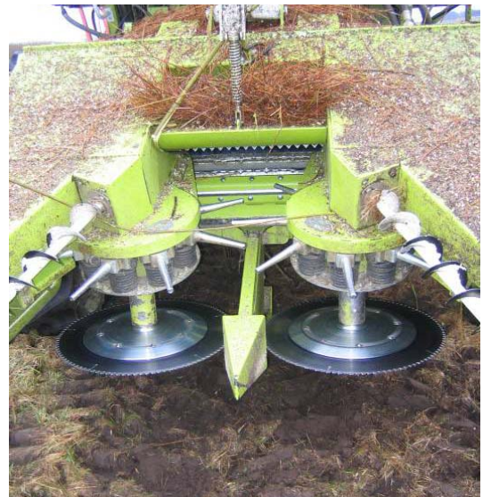
Det 2-rækkede Claas HS-2 skærebord med to savklinger.
