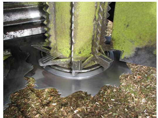
Tildannede klinger af 8 mm tykke hårdmetalplader.
