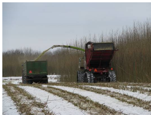
Høst af flis direkte i frakørselsvogn.
